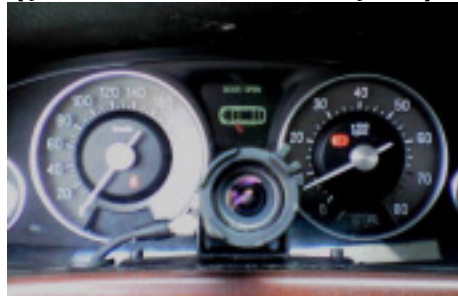
Ο αισθητήρας παρακολούθησης των οφθαλμών του οδηγού
