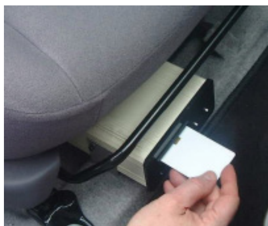
ΕΙΚΟΝΑ 5-9: Σύστημα καταγραφής δεδομένων οδήγησης και κατανάλωσης
